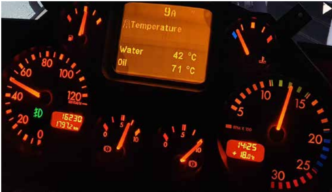
Рис. 10. Результат роботи пристрою в режимі трансивера в парі з панеллю приладів
